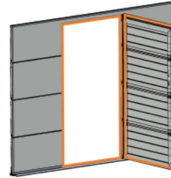
Etanchéité maximale : un joint périphérique et un joint d'amortissement (anti-claquement)
