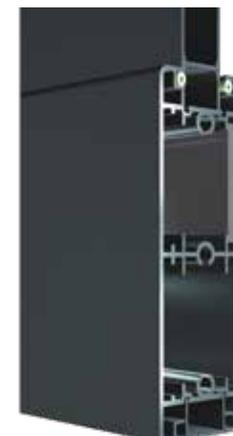
Nos portails cachent dans leur structure des renforts aluminium d'une épaisseur de 10 mm. Ils sont insérés dans les profilés pour recevoir les fixations moteurs ou tout autre accessoire nécessitant une accroche renforcée.
