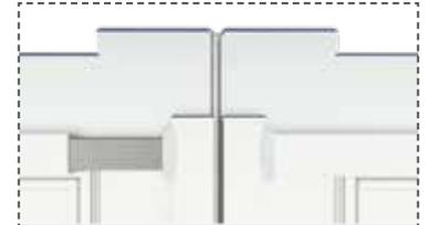
Cadre Inox soudé sur 4 faces recouvert d'un gainage blanc avec clé de gainage
